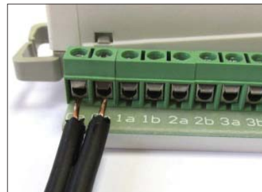
Рисунок 7 – Подключение провода ПРППМ к дополнительным винтовым клеммам плинта.
