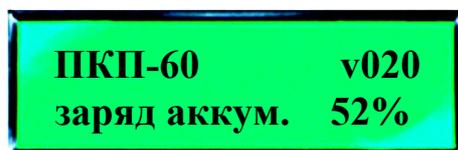
В верхней строке указана модификация исполнения прибора, в нижней – уровень зарядки аккумуляторов (цифра приблизительная, зависящая от степени износа аккумуляторов). Состояние прибора, при котором на дисплей выведена эта надпись, называется ниже «*εἰδοίαι*».
