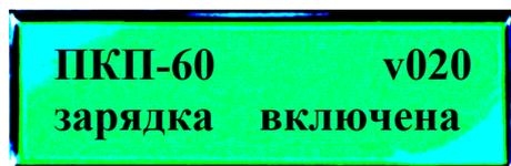
Время полной зарядки аккумуляторов может составлять более 10 часов. Адаптер может быть подключен к прибору постоянно.
