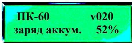
В нижней строке дисплея показан уровень зарядки аккумуляторов (цифра приближительная, зависящая от степени износа аккумуляторов).
