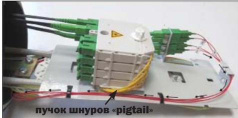
**10.1.7** Нанести отметку маркером (темного цвета) на буферном покрытии шнуров «pigtail» в месте предполагаемой сварки с ОВ (в буферном покрытии) кабеля. Обрезать поочередно излишки длин шнуров «pigtail» по нанесенным меткам. Отключить шнуры «pigtail» от адаптеров.
