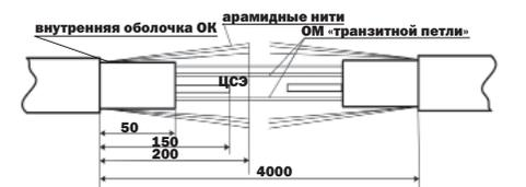
**Схема Б разделки при транзитном вводе:**
