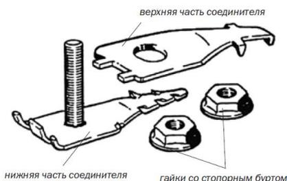
Рис. 2.3. Комплект соединителя экрана 4460-D.
