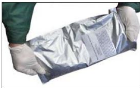
Рис. 8. Смешивание компонентов герметика.
