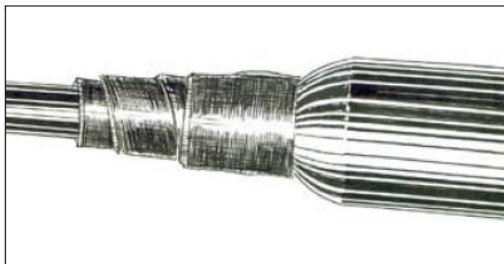
Рис. 11. Конусная часть муфты МГРг с намотанной лентой VM.
