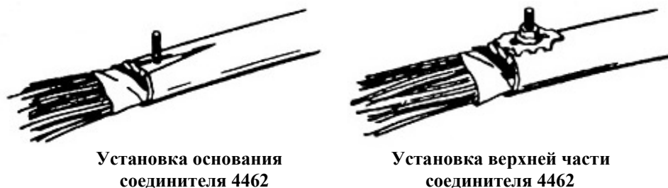
Рис. 3. Установка соединителя экрана 4462.
