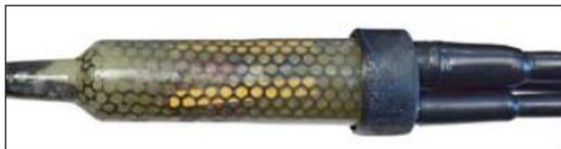
Рис. 10.Сросток разветвительной муфты МГРг после удаления корпуса.
