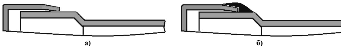
Рис. 5. Форма шва на стыке оголовника и корпуса МСР. Припой закрашён чёрным цветом: а – до наложения припоя; б – сформированный и разглаженный паяный шов.
